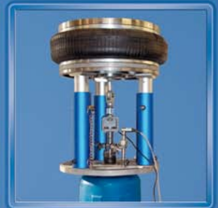
Dispositivo de comprobación SAFE para comprobación de válvulas instaladas sin incremento de presión de caldera, sin pérdida de producto
