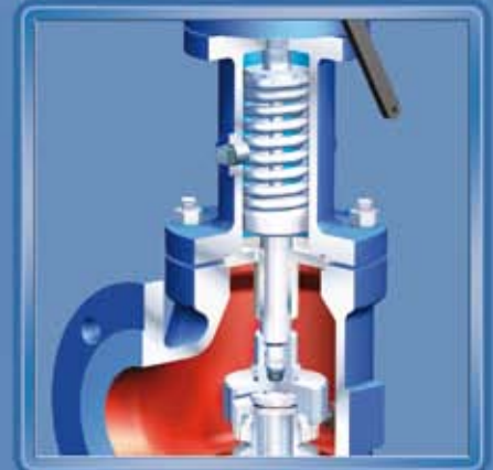
Eje de dos piezas que asegura una óptima guía del disco sobre el asiento
