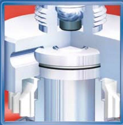
Disco reversible (la estanqueidad se realiza en ambas caras), asegura un fácil servicio y mantenimiento
